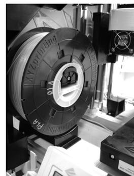
Öffnen Sie zunächst den Freigabearm, ziehen Sie das Filament dann mit den Spulenachsen heraus. Legen Sie sie zur späteren Benutzung zur Seite.
