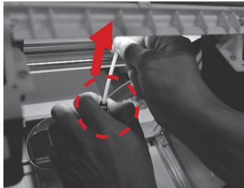
5. Drücken Sie leicht auf die Feder rund um das Zufuhrloch und entfernen Sie das Filamentführungsrohr (weißes flaches Kabel nicht trennen)
