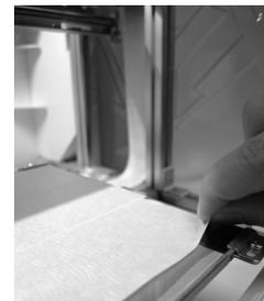
2. Bringen Sie das Plattenklebeband an der Druckplatte an.
