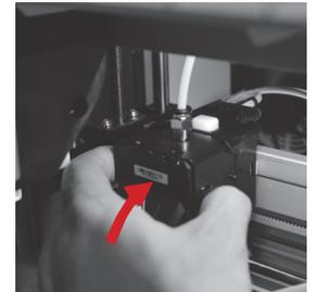
7. Installieren Sie nach Reinigung des Zufuhrpfads das Führungsrohr wieder an der Oberseite des Extruders und installieren Sie den Extruder an der Halterung.
