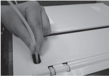
**1** Führen Sie das Führungsrohr vom Rohrbewegungsbereich von der Maschine weg und stecken Sie dann das andere Ende des Filamentrohrs in den Rohranschluss des Zuführmoduls.
