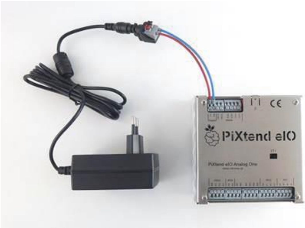
Abbildung 26: Anschluss des Netzteils an PiXtend eIO
