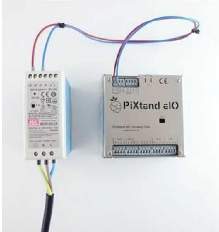
Abbildung 27: 24V; 2,5A Hutschienennetzteil an PiXtend eIO angeschlossen
