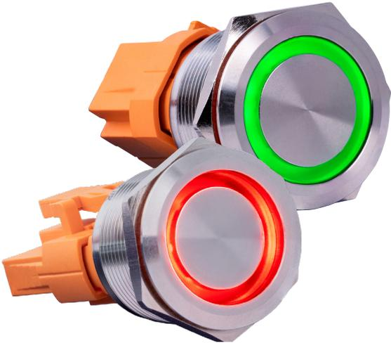
Unser rastender / tastender Stahl­taster über­zeugt durch hoch­wertige Mate­rialien, Schutz­klassen und Ergo­nomie. Er ist aus rost­freiem Stahl gefertigt und erfüllt die Schutz­klassen IP65 (Staub und Wasser), IK10 (Schlag) und PA66 (Flamme). Durch die Schutz­klassen, dem großen Tem­peratur­bereich und der Langleb­igkeit ist unser Stahl­­taster für viele An­wen­dungen geeignet. Der Stahl­­taster verfügt über einen leucht­starken LED Ring (grün / rot).
