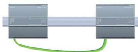
Bei direkter Verbindung zwischen zwei CPUs:
