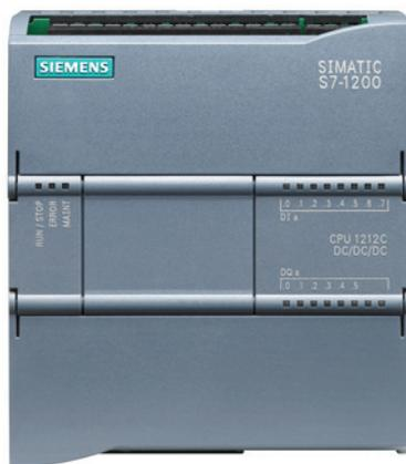
Dieser Zyklus wird als Abtastzyklus oder Abtastung bezeichnet. Unter Standardbedingungen werden alle digitalen und analogen Ein- und Ausgänge synchron zum Zyklus mit einem internen Speicherbereich, dem so genannten Prozessabbild, aktualisiert. Das Prozessabbild enthält ein Momentabbild der physischen Ein- und Ausgänge von CPU, Signalboard und Signalmodulen.
