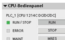
Mit der Schaltfläche auf dem Bedienpanel ändern Sie den Betriebszustand (STOP bzw. RUN). Außerdem enthält das Bedienpanel eine Schaltfläche MRES zum Umräumen des Speichers.
