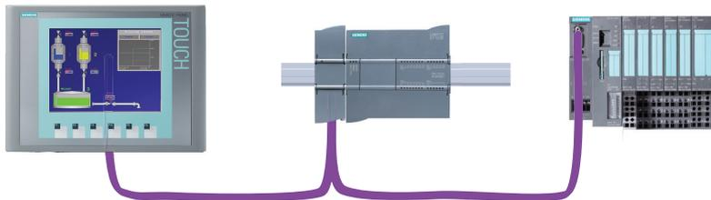
Wenn ein CM 1242-5 und ein CM 1243-5 zusammen installiert sind, kann eine S7-1200 gleichzeitig sowohl als Slave eines übergeordneten DP-Mastersystems als auch als Master eines untergeordneten DP-Mastersystems fungieren.
