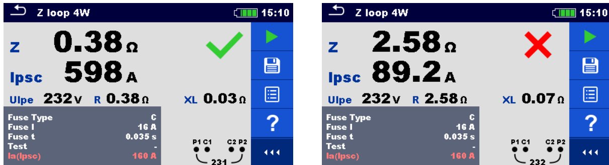
Abbildung 7.45: Beispiel für das Ergebnis einer Z loop 4W Messung
