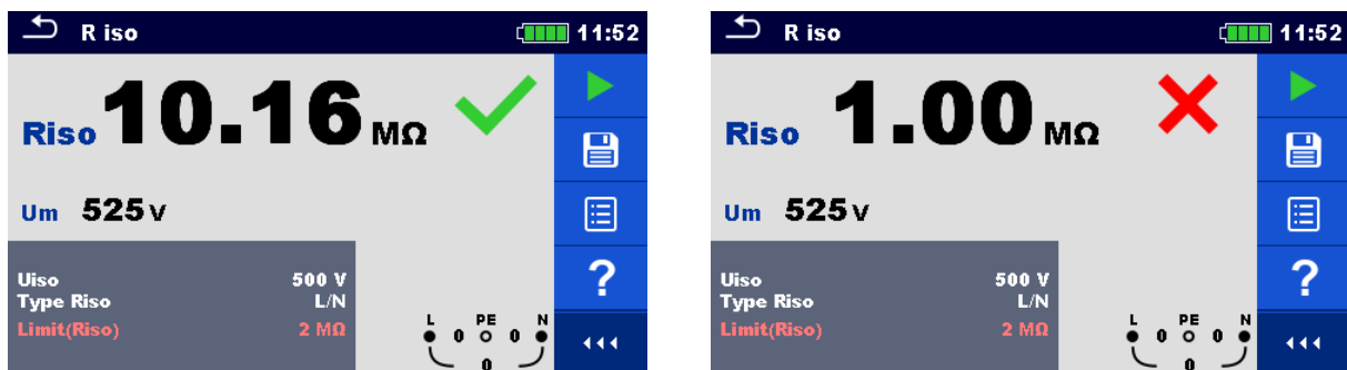
Abbildung 7.9: Beispiele für Ergebnisse der Isolationswiderstandsmessung
