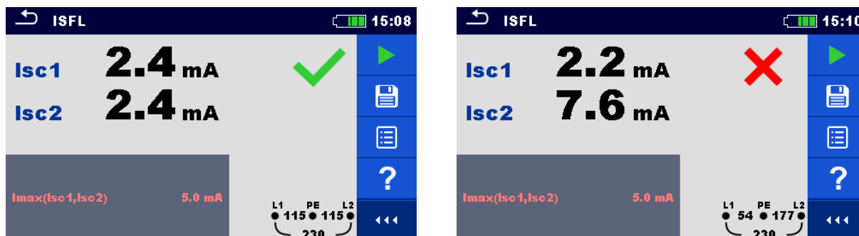
Abbildung 7.92: Beispiel für die Messergebnisse des ersten Fehlerableitstroms
