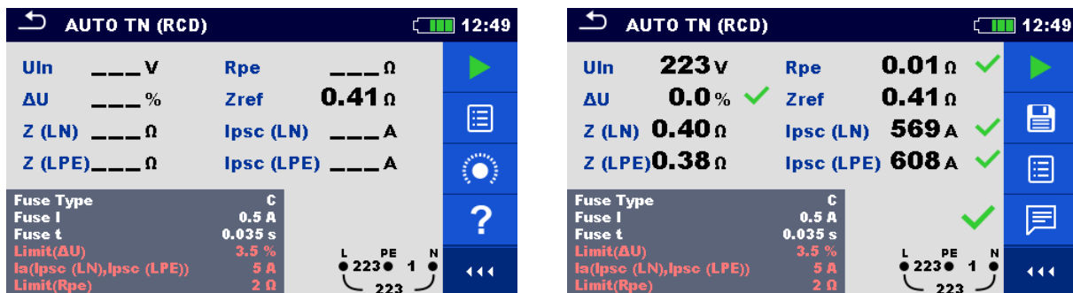
Abbildung 7.111: Beispiele für Ergebnisse der AUTO TN (RCD) Messung
