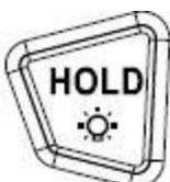
HOLD: kurzer Tastendruck, um das Messergebnis zu halten. Langer Tastendruck um die Hintergrundbeleuchtung zu aktivieren/ deaktivieren.
