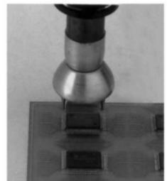
und kontrollieren Sie die Bestückung sorgfältig auf Lötfehler wie Brücken, Lotperlen, Unterbrechungen etc.
