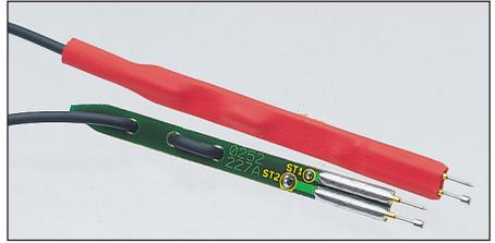
**Bild 1: Spezial-Messleitungen mit federnd gelagerten Messspitzen**
