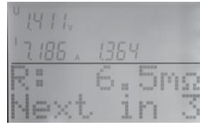
**Bild 23: Hauptfenster der Ri-Messfunktion**
