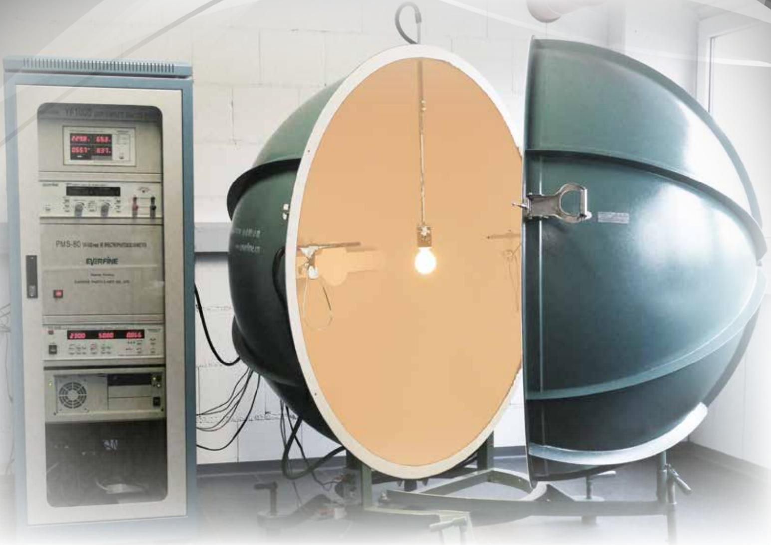
In unserem Labor stehen u.a. mehrere Ulbrichtkugeln in unterschiedlichen Größen zur Verfügung.
