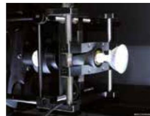
Winkelmessungen werden im Goniospectrophotometer durchgeführt.
