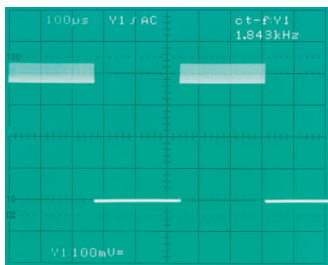
Bild 12: Analogbetrieb offenbart: Die Frequenz der Überlagerung ist hoch (HAMEG Gerät)
